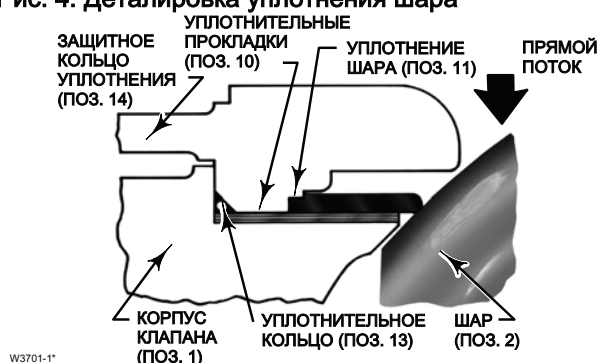
Рис. 4. Детализовка уплотнения шара
