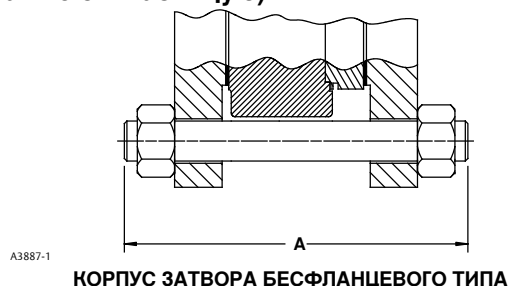
Рис. 2. Резьбовые шпильки для установки (также см. таблицу 5)
