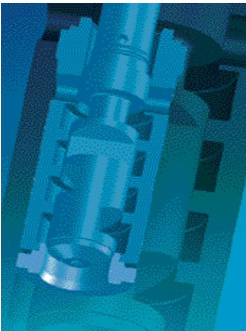
*Проходные и угловые клапаны с 3- и 4-ступенчатым антикавитационным тримом NotchFlo DST, рассчитанным на эксплуатацию в жестких условиях для работы под высоким давлением позволяют управлять расходом жидкостей с большим перепадом давления (до 170 бар) избегая при этом опасности повреждений в результате воздействия кавитации.*
