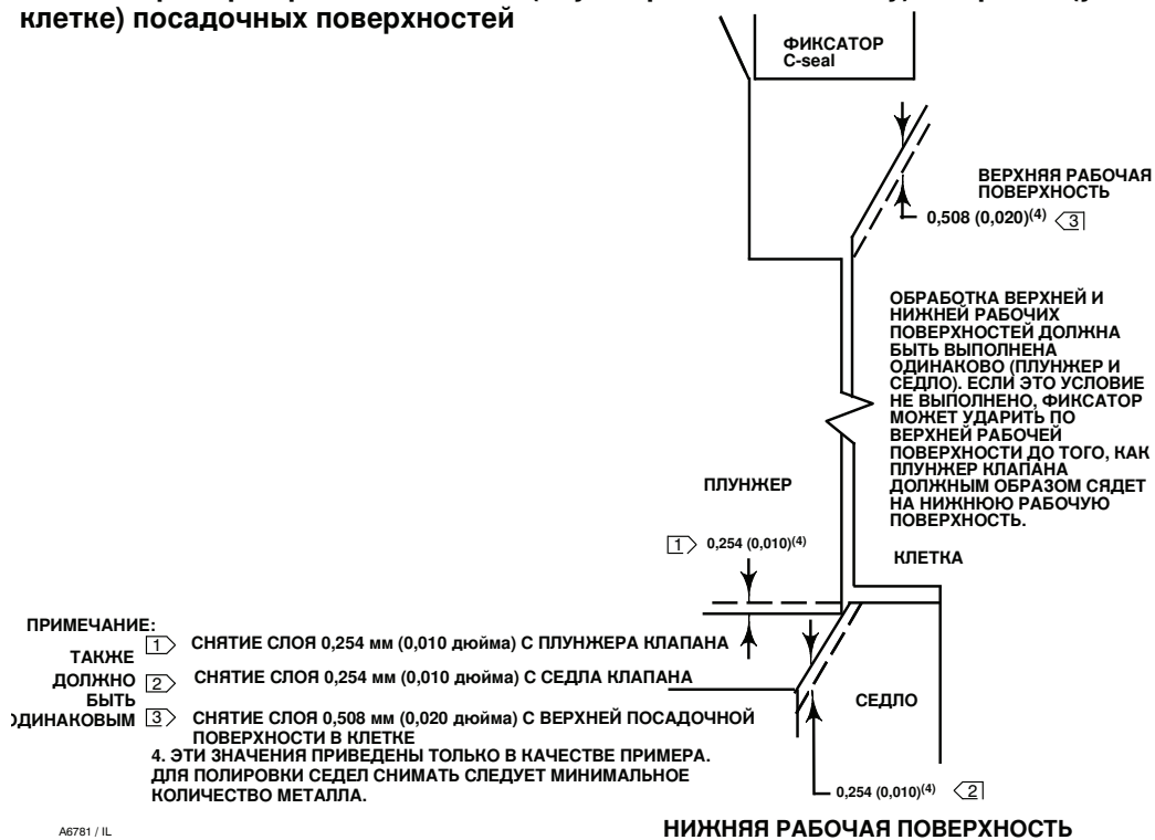
Рис. 15. Пример обработки нижней (плунжер клапана к седлу) и верхней (уплотнение C-seal к клетке) посадочных поверхностей
