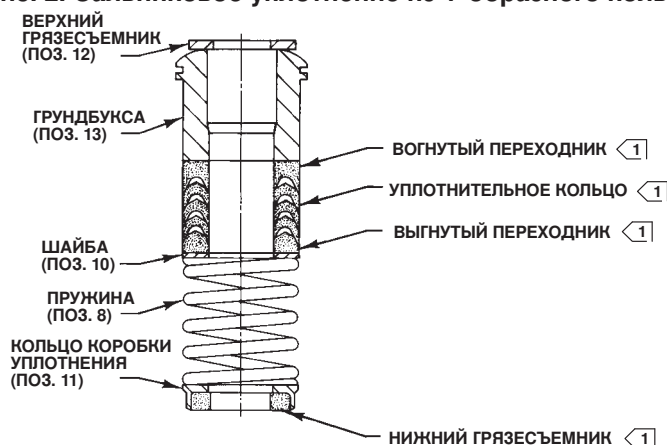
Рис. 2. Сальниковое уплотнение из V-образного кольца из ПТФЭ
